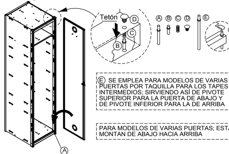
(E) SE EMPLEA PARA MODELOS DE VARIAS PUERTAS POR TAQUILLA PARA LOS TAPES INTERMEDIOS; SIRVIENDO ASÍ DE PIVOTE SUPERIOR PARA LA PUERTA DE ABAJO Y DE PIVOTE INFERIOR PARA LA DE ARRIBA
